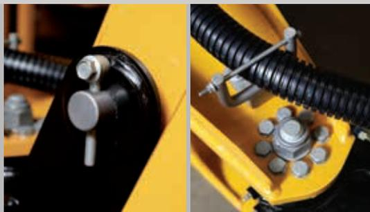
Специальная обработка пальцев шарнира, втулок и зажимного оборудования в целях обеспечения оптимального предотвращения коррозии.
