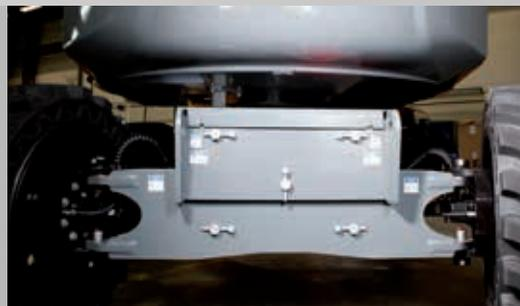
Защитная система внутри шасси для того, чтобы избежать потенциальных повреждений вследствие от ударов.
