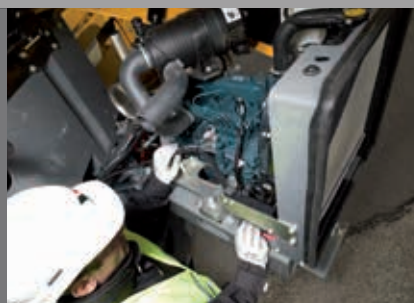
Откидывающийся двигатель обеспечивает прямой доступ к главным деталям
